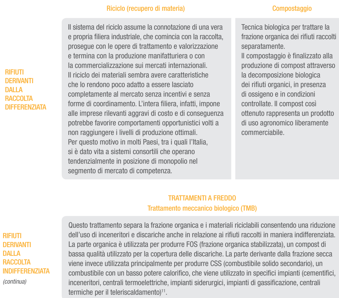
Figura 2 – Le tipologie di trattamento dei rifiuti
